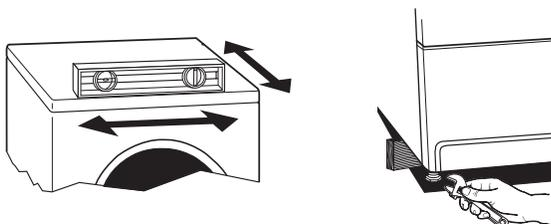
Si la sécheuse n'est pas d'aplomb, la relever à l'aide d'un bloc de bois. Utiliser une clé pour ajuster les pieds vers le haut ou vers le bas, et vérifier à nouveau si elle est d'aplomb.
