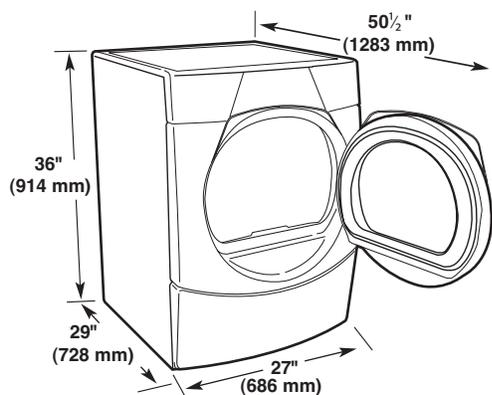
**REMARQUE :** La plupart des installations requièrent un espace minimum de 5" (127 mm) derrière la sécheuse pour le conduit d'évacuation avec coude. Voir "Exigences concernant l'évacuation".
