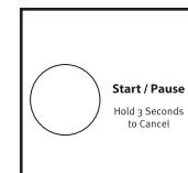
Si l'on doit ouvrir le couvercle, appuyer sur le bouton START/PAUSE (mise en marche/ pause). Le couvercle se déverrouille une fois que le mouvement de la laveuse a cessé. Il se peut que cela prenne plusieurs minutes si la laveuse essorait la charge à grande vitesse.
