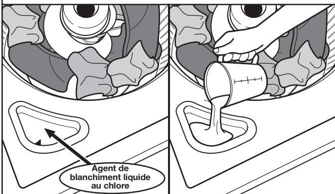
Ne pas remplir excessivement le distributeur ni utiliser plus 1 tasse (236 mL) d'agent de blanchiment liquide au chlore. Ne pas utiliser d'agent de blanchiment sans danger pour les couleurs ni de produit Oxi avec un programme utilisant de l'agent de blanchiment au chlore liquide.
