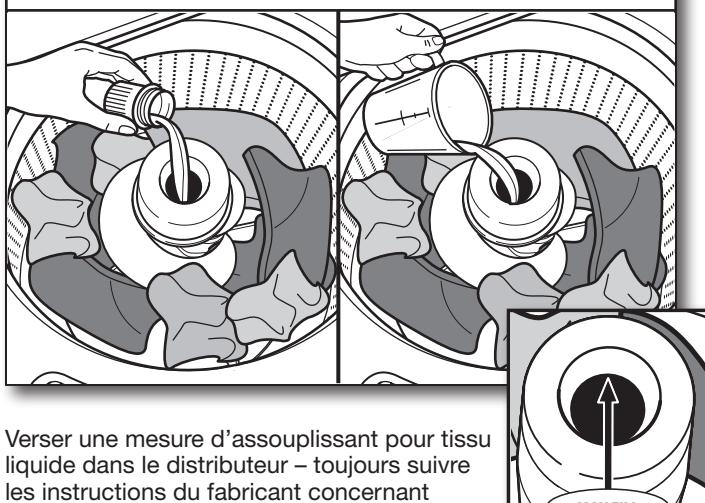
Verser une mesure d'assouplissant pour tissu liquide dans le distributeur – toujours suivre les instructions du fabricant concernant la dose d'assouplissant pour tissu à utiliser en fonction de la taille de la charge.
