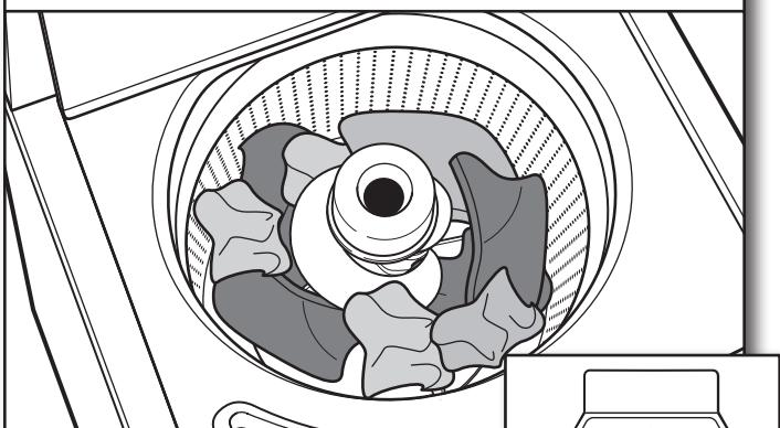
Charger les vêtements sans les tasser et de façon uniforme le long de la paroi du panier. Pour de meilleurs résultats, ne pas remplir au-delà de la hauteur maximale de charge recommandée. Ne pas enrouler de grands articles tels des draps autour de l'agitateur; les charger sans les tasser le long de la paroi du panier. Essayer de mélanger différents types d'articles pour réduire l'emmêlement.
